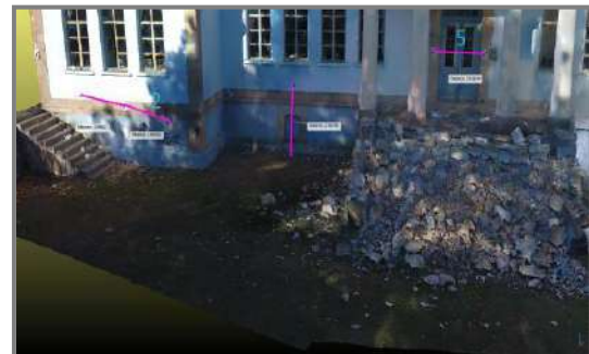
Εικόνα 12: Μετρήσεις ευκλείδειων αποστάσεων στο 3D νέφος σημείων, Site Scan
