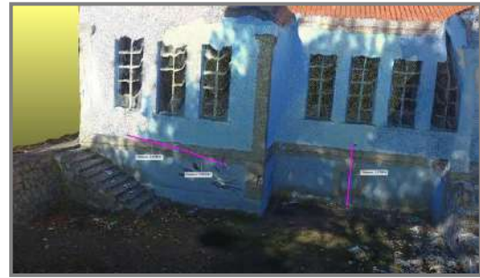
Εικόνα 4: Μετρήσεις ευκλείδειων αποστάσεων στο 3D νέφος σημείων, Top-Down
